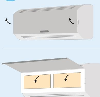
Provjerite je li klima uređaj isključen. Da biste uklonili filtre, otvorite prednju ploču i nježno ih podignite sa okvira.
